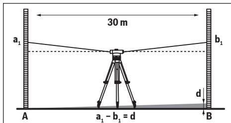
После выравнивания и фокусировки измерительного инструмента считайте значение высоты на обеих нивелирных рейках. Подсчитайте разницу **d** между высотой **a<sub>1</sub>** на нивелирной рейке **A** и высотой **b<sub>1</sub>** на нивелирной рейке **B**.
