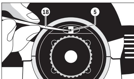
Открутите крышку окуляра **4**. С помощью стержня для настройки **18** поворачивайте юстировочный винт **5** по часовой стрелке/против часовой стрелки, пока при измерении на нивелирной рейке **B** не будет достигнуто рассчитанное значение высоты **b<sub>2</sub>**.
