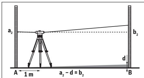
Установите измерительный инструмент на расстоянии ок. 1 м от нивелирной рейки **A**. После выравнивания и фокусировки измерительного инструмента считайте значение высоты **a<sub>2</sub>** на нивелирной рейке **A**.
